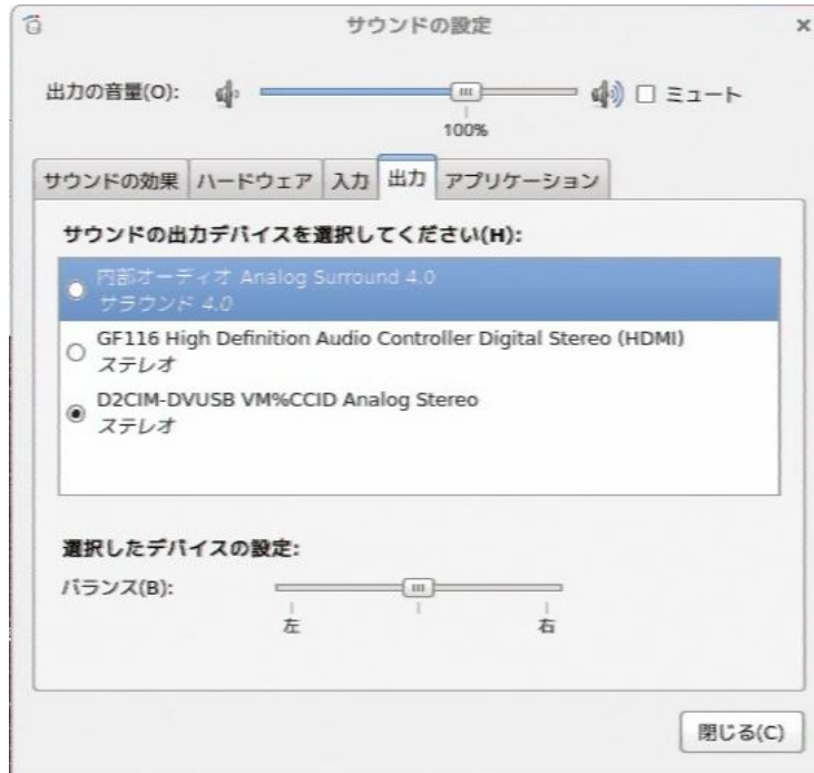
図 10: 出力を KVM_over_IP の機器 D2CIM-DVUSB に切り替える。すると、手元のスピーカーから音声出力が得られる
