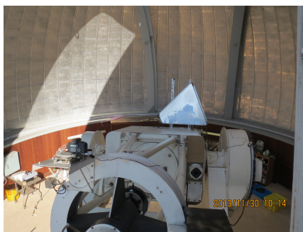
望遠鏡の背中に搭載。集光面積は71cm鏡相当
