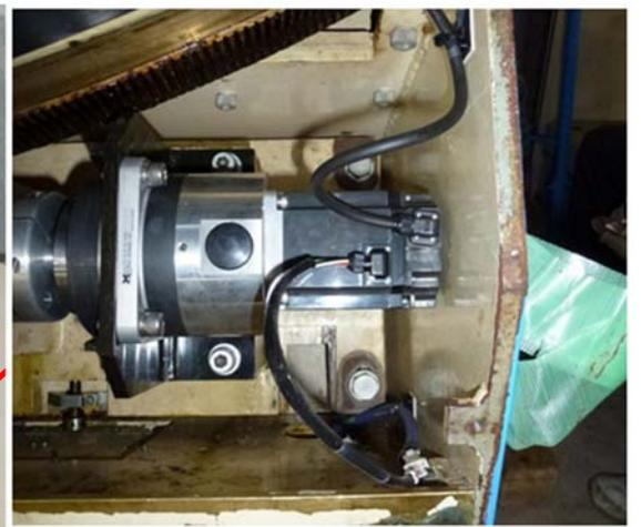
図5. 赤経軸微動駆動部は1F機械室内にあったが、高出力小型モーターの使用でギヤボックス内に収められた。
