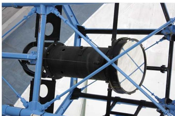
図9. 外装はそのままだが、内部の駆動部が更新されたカセグレン・クード副鏡駆動部ユニット
