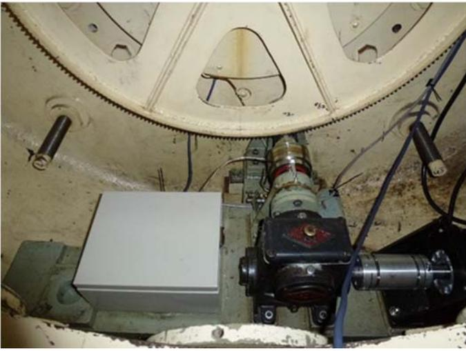
図2. バランスウエイト部内部の赤緯軸粗動系。赤経軸粗動系とともに、機構がシンプルになった。
