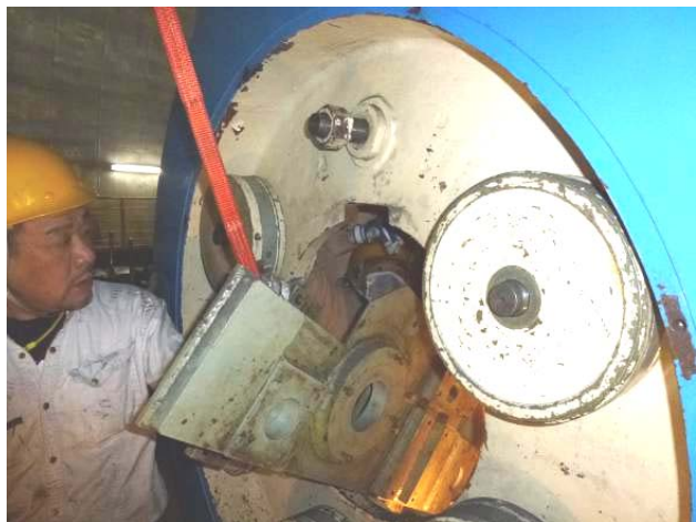
図8. 赤緯軸粗動駆動系のベースの取り出し。そのままではRA軸バランスウェイト部の中心穴から取り出せず、中心穴を一部削って切欠きを作って取り出した。
