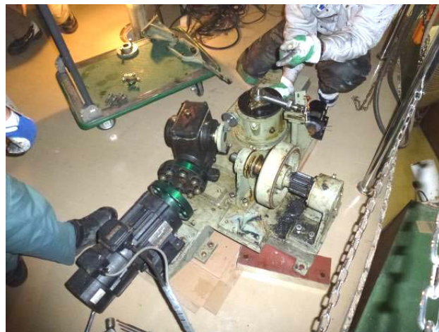
図9. 取り外された赤緯軸粗動駆動系。主に機械式クラッチとモーターからなる。
