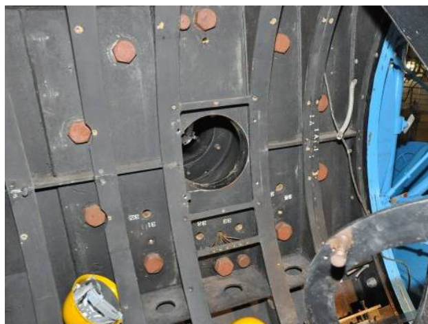
図13. センターピースと赤緯軸を締結している太いボルト群。これはそのまま
