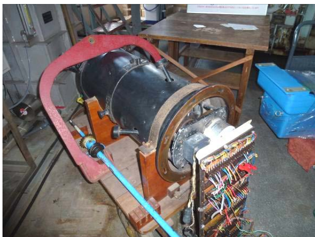
図4. 取り外されたカセグレン・クーデ副鏡駆動ユニット
