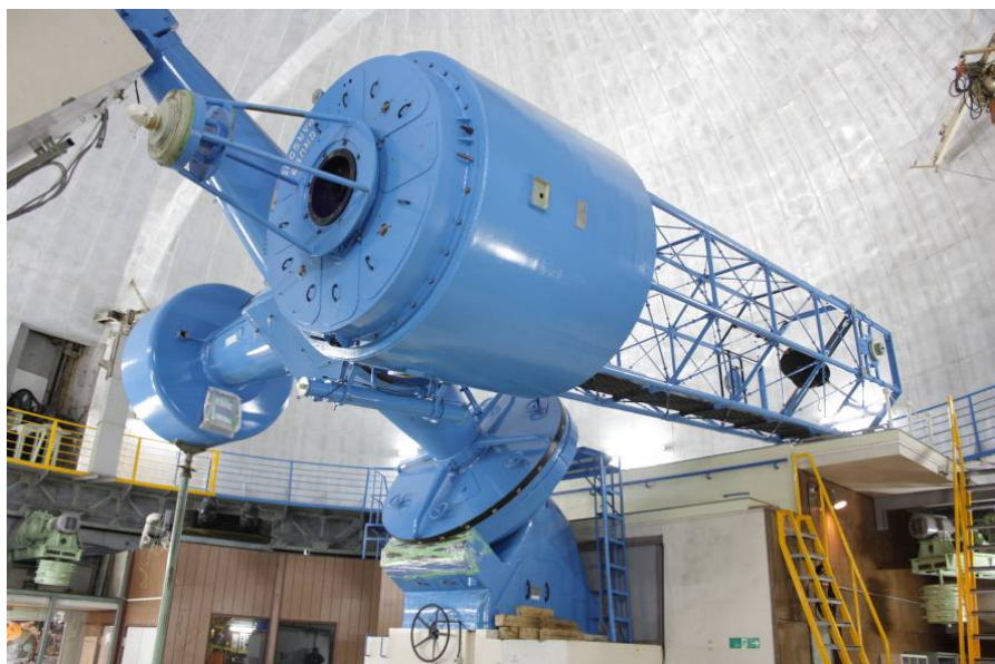
図 18. 解体作業後の 188cm 望遠鏡。一見、普通の状態ですが、各種モーターやセンサーが取り外され動かすことができません。ケーブル類が取り外されているので、いつもより幾分すっきりして見えるかもしれません。新しい心臓部の組み込みを心待ちにしています
