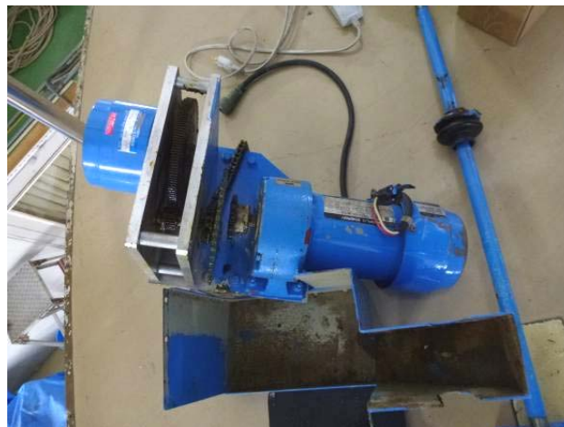
図3. 取り外されたカセグレンローテータ駆動部
