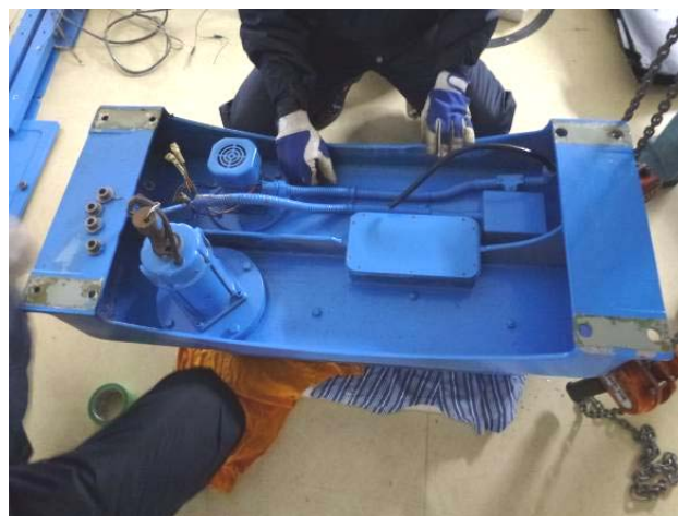
図7. 取り外された赤緯軸微動ユニット。セット（中速）とガイド（低速）の駆動モーターが左側に見える
