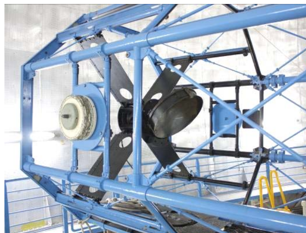
図5. ニュートン副鏡ユニットを取り付け、バランスを調整している
