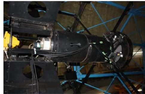
図8. 副鏡焦点調節機構を支持しているスパイダー (黒い板状の部分)
