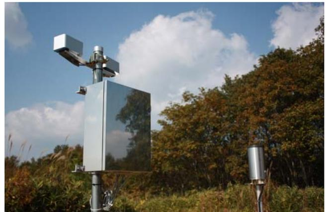
（図4）更新された雨滴センサー（手前）と雨量計
