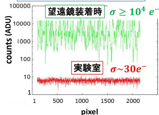
望遠鏡装着時に読み出し不良発生
