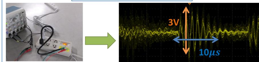
望遠鏡モーターのインバータ由来のノイズ発見
