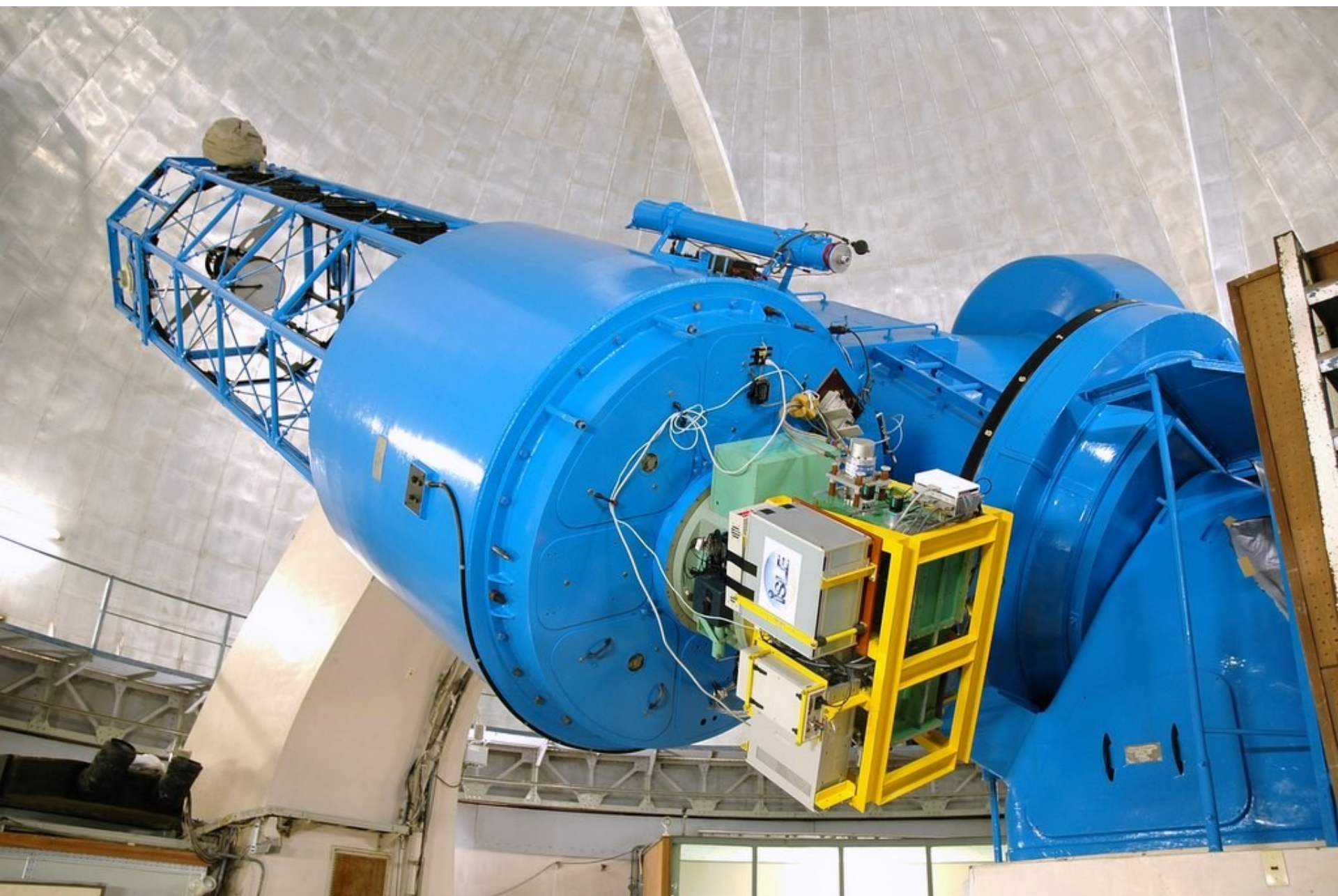
188cm望遠鏡のカセグレン焦点に取り付けられた ISLE
