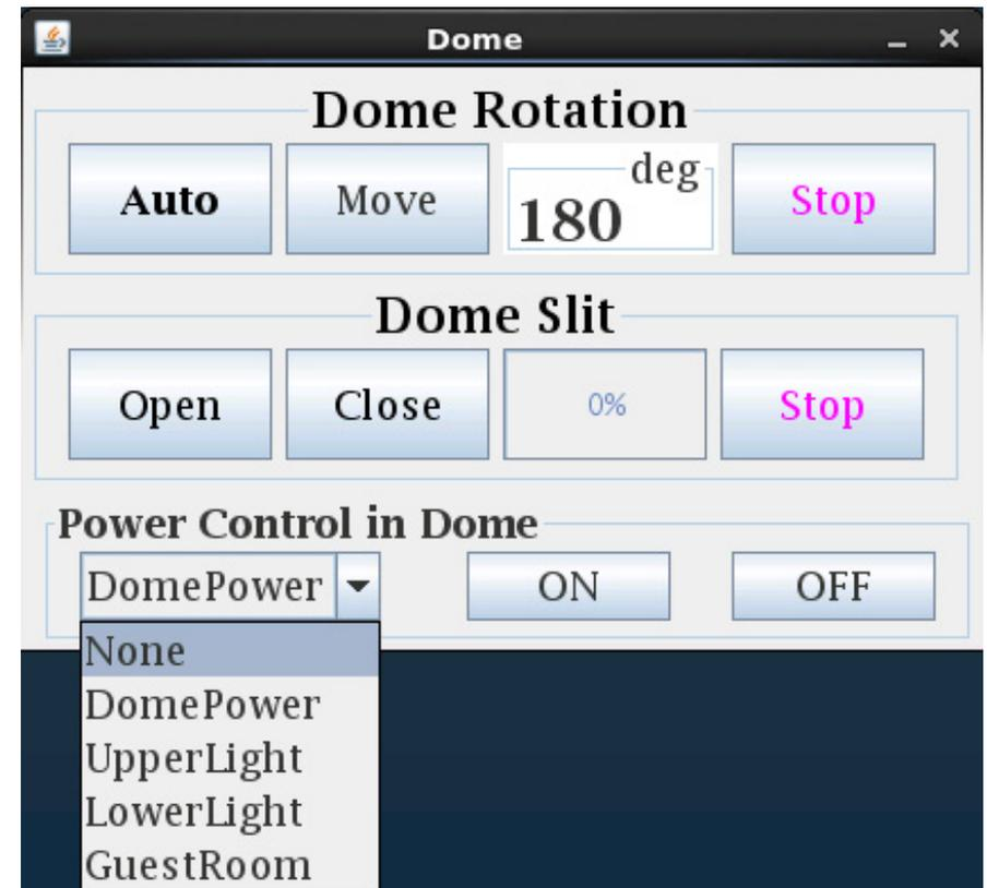
ドーム駆動電源のON/OFFとドーム内照明のON/OFFをGUIから操作できる。
