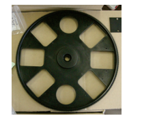
Fig. 8 ソルブラック(旭プレジジョン)で表面処理をしたグリズムホルダー
