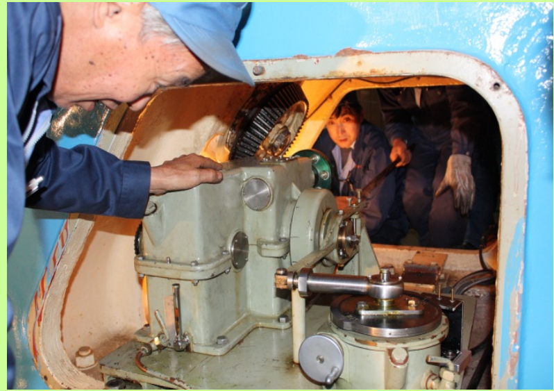
望遠鏡赤経軸駆動機構 (南側架台上の軸受部の下にある)
