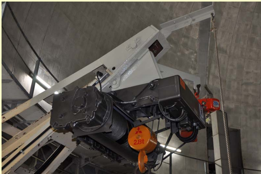
鏡吊り用2.5tクレーンが更新されました(H23.03)
