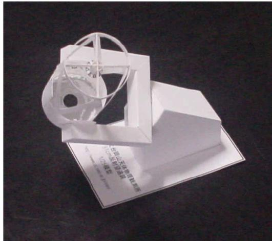
その後、赤緯軸を鏡筒の赤緯軸の穴の外側から通した後で広げて仮固定し、必要に応じて赤緯軸押さえを鏡筒の内側から赤緯軸に固定する。この際に、赤緯軸押さえが鏡筒に接着されてしまわないように注意する。
