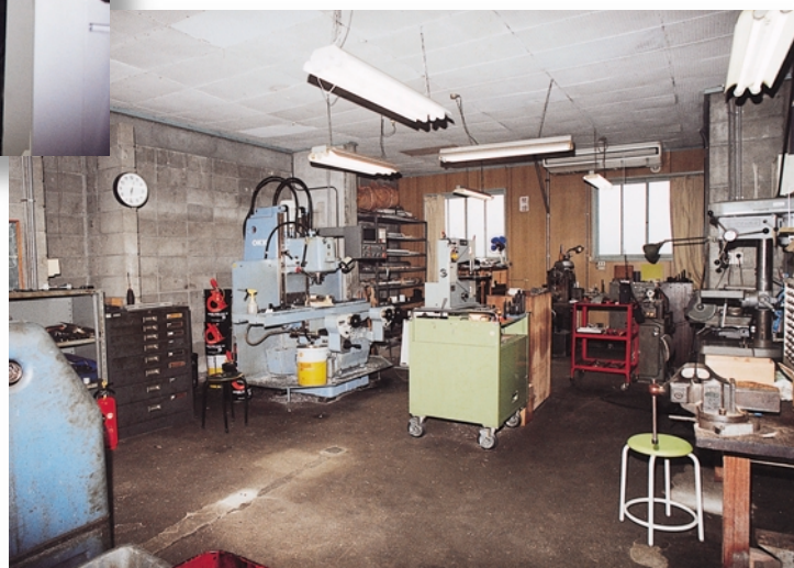
実験工場（2001年） 中央に見えるのが中型半自動フライス盤 左手前が中型旋盤 右奥に小型旋盤 その他帯鋸盤、ボール盤などがある
