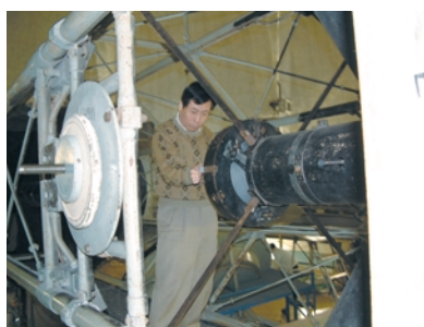
11. 副鏡縁にバッフルを取り付ける
