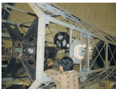
7. ホイストを使って副鏡を移動する
