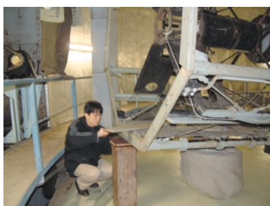
1. 赤緯軸固定用のロープを張る
