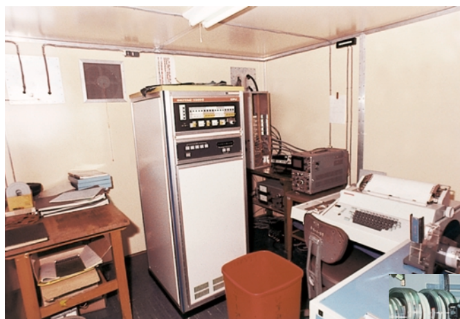
図3-53 広波長域分光測光器に使用された初代計算機 ミニコン OKITAC4300C メインメモリ 4Kワード 入出力 紙テープ
