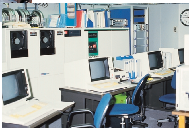
図3-54 FACOM スーパーミニコン S3300 メインメモリ6MB ディスク727MB 入出力 磁気テープ
