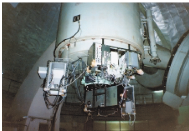
図3 - 63 188cm反射望遠鏡に取り付けられた京都三次元分光器
