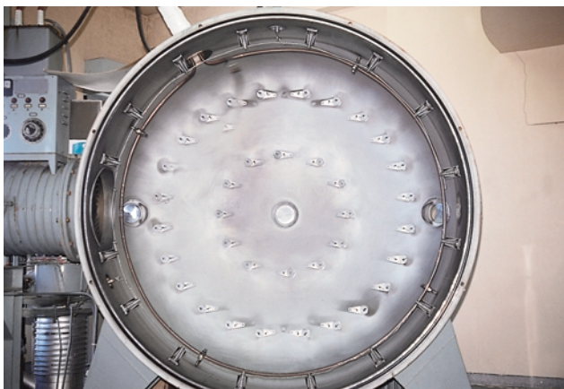
⑩真空タンク 内側12本外側24本計36本の電極がみえる。さらに外側に見える銅パイプはマيسナーコイルと呼ばれている。ここに液体窒素を流し込むと空気分子が表面に吸着し、真空度を上げることができる
