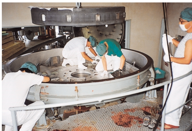
木曽観測所の105cmシュミット望遠鏡主鏡をタンクにセットするため準備をしている。上側に見えるのが主鏡
