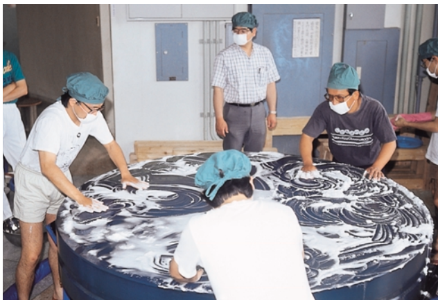
⑦水洗後、重炭酸ナトリウムで鏡面を研磨する
