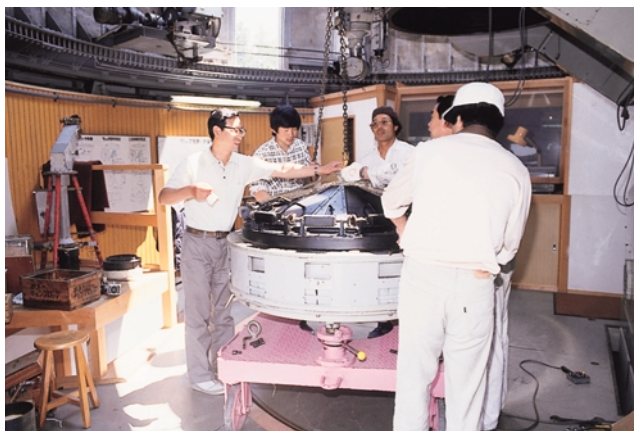
1. 91cm反射望遠鏡の主鏡セルを望遠鏡から外す
