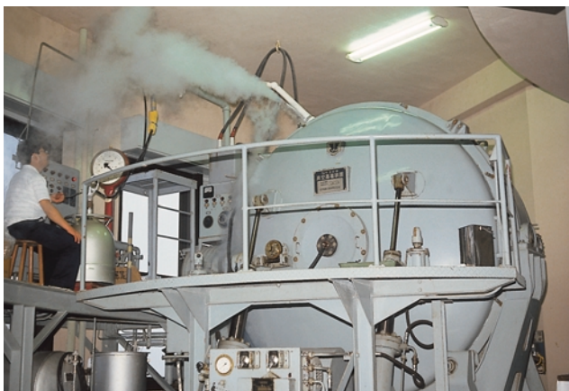
⑪ 7 \times 10^{-5} Torrの圧力に到達した時、マيسナーコイルに液体窒素を流すと一気に 6 \times 10^{-6} Torrになる。イオンボンバードの後にアルミニウムを蒸発させる。膜厚は約80nm
