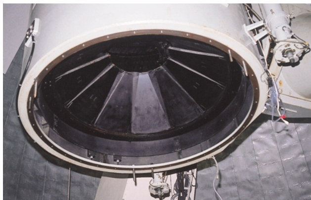
②主鏡セルを外した188cm反射望遠鏡。鏡筒側についたミラカバーが見える
