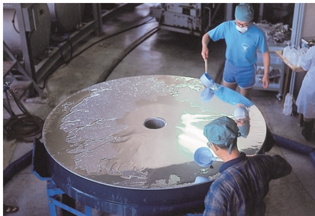
⑥10%苛性ソーダ溶液で古いアルミニウム膜を剥がす
