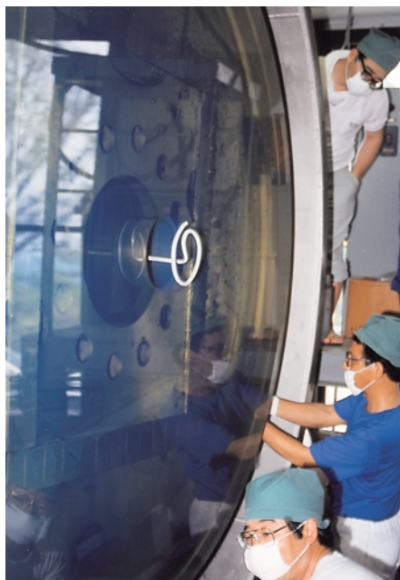
⑨蒸着釜へ固定され、立てられた主鏡
