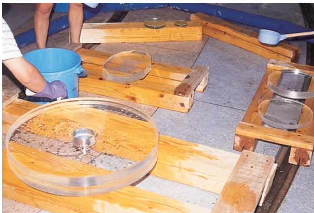
65cmクーデ型太陽望遠鏡の主鏡、副鏡、クーデ鏡の洗浄が済んだところ。このようにいろいろな鏡の蒸着を行う
