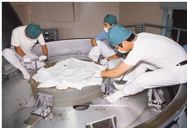
4. 91cm主鏡を蒸着タンクにセットしている。タンクは埃、油、水分など嫌うので作業には気を遣う
