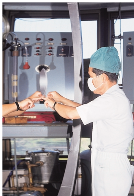
⑫蒸着後の鏡面検査 生成されたアルミニウム膜の強さをテストしている。鏡面にスコッチテープを貼り付け、勢いよく剥がす。テープにアルミ膜が付着していなければ合格
