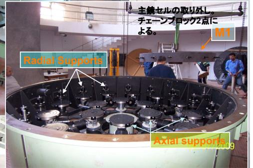
主鏡セルの取り外し。チェーンブロック2点による。
