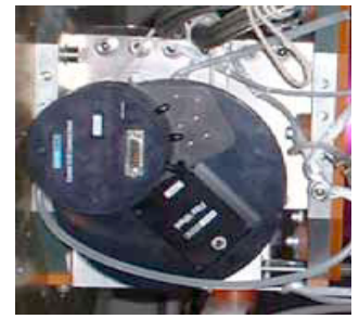
可視カメラ BITRAN 製 検出器: BT-214E 1024*1024 7.0*7.0分角、0.41秒角/pixel
