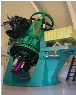
ぐんま天文台 1.5m 反射望遠鏡 + 各種観測装置
